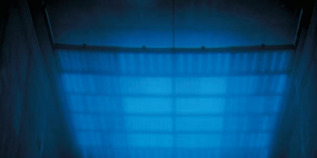
*Blick auf die Quellenwand im Wasserbecken. Die Strahlung regt die Wassermoleküle an. So entsteht das charakteristische blaue Leuchten, die sogenannte Tscherenkow-Strahlung.*
