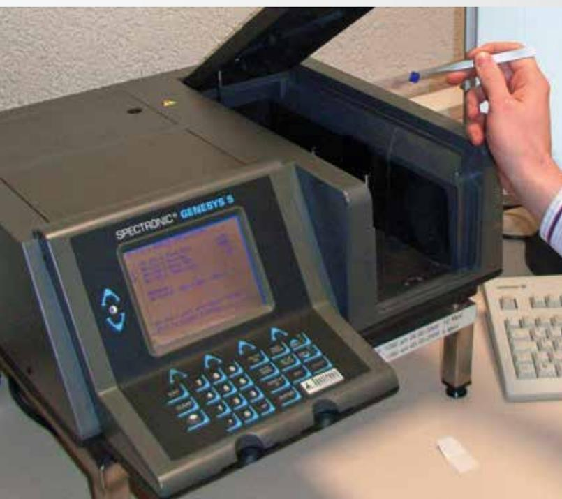
*Les dosimètres s'éclaircissent et permettent de connaître précisément la dose d'irradiation ponctuelle.*
